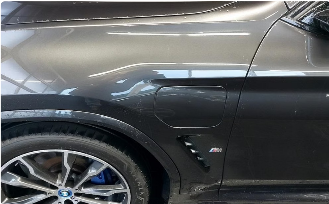
Obrázok 16: Poškodenie tankovacej klapky
